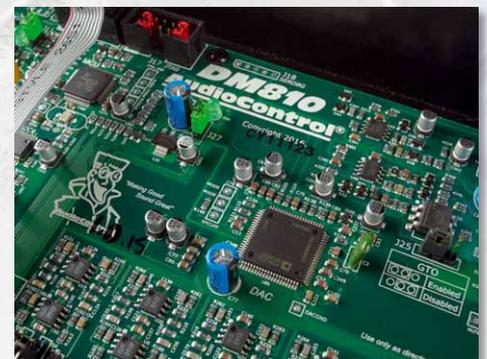
Die linke Hälfte der Platine enthält die Eingangsverstärkung, die 4 ADC, im Bild ist der DAC
