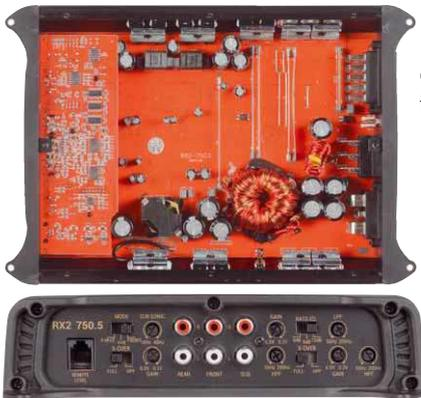
Die mittelgroße RX2 zeigt auf der Hauptplatine gähnende Leere. Alles außer den großen Spulen und Kondensatoren ist versteckt
