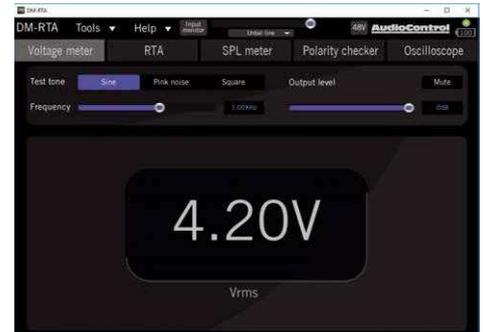
Voltmeter: Mit einem Sinussignal lässt sich der Output von DSPs, Verstärkern etc. bestimmen
