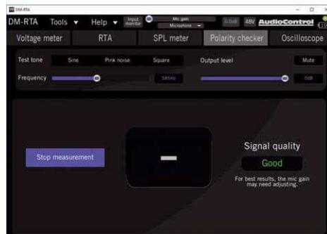
Praktisch: Mit der Polaritätsprüfung wird der richtige Anschluss von Lautsprechern überprüft
