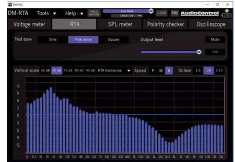
Die kontinuierliche Frequenzgangmessung (hier mit 1/6-Oktav-Balken) zeigt hier eine schlechte Summierung von Tief- und Hochtönen mit Trennung bei 3 kHz
