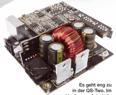
Es geht eng zu in der QS-Two. Im Vordergrund sind die Netzteiltransistoren, die am Kühlkörper andocken
